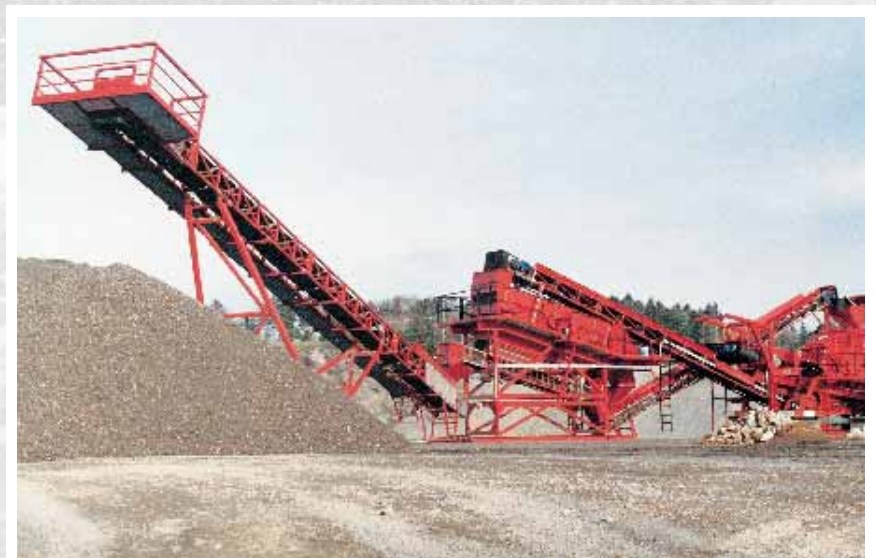
Beispiel 2: FMS Förderbandwaage in einer Straßenabbruch-Aufbereitungsanlage. Kapazität 50 t/h
